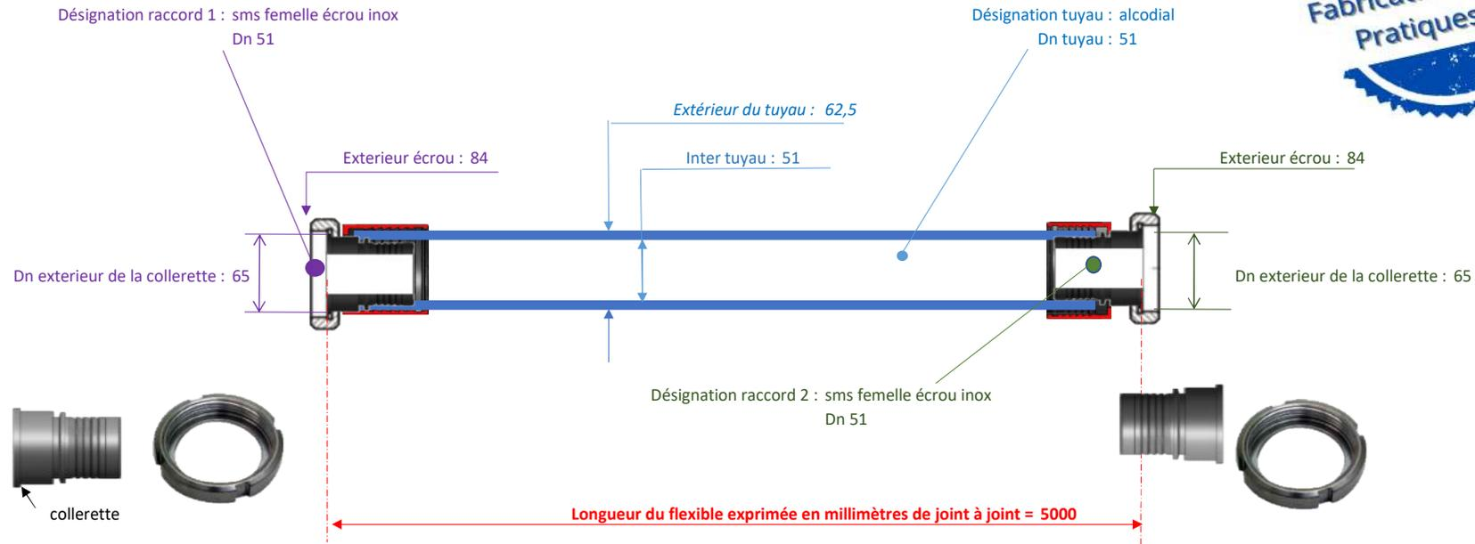
Aide à la définition d'un raccord : <https://www.flex-key.com/dimension-des-raccords/>
