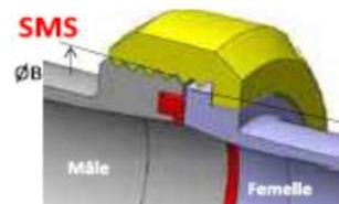
Aide à la définition d'un raccord : <https://www.flex-key.com/dimension-des-raccords/>
